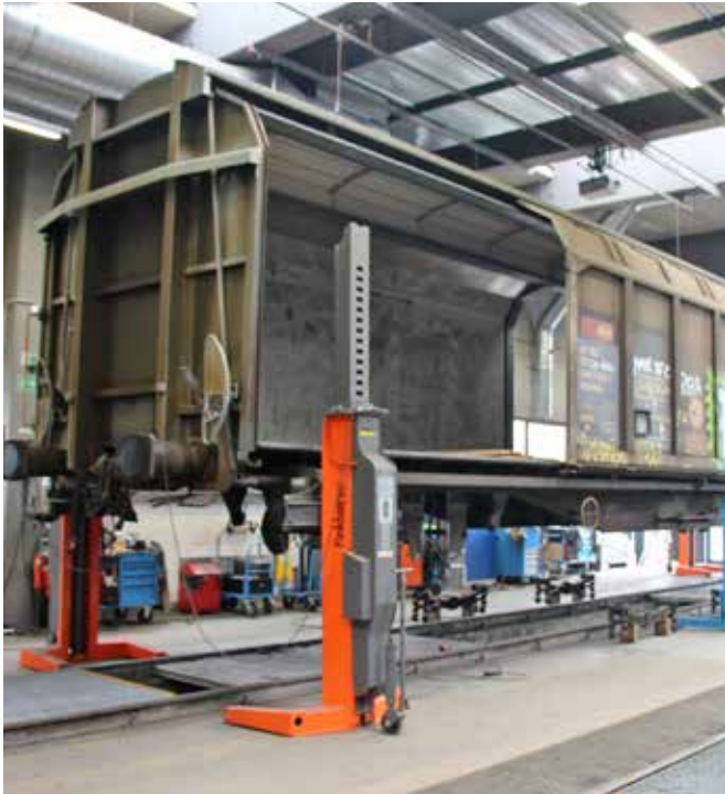
EHB907KDC - 7,5 t , wireless, corsa utile di sollevamento 1750 mm
