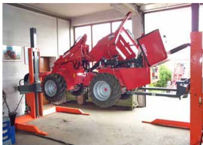
EHB706G1DC-2 - 2x6,5 t , wireless, ruota da Ø550-1420 mm, forche da 590 mm
