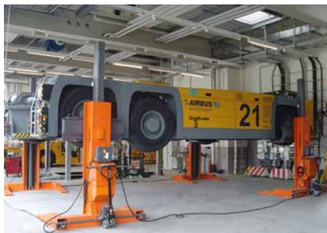
EHB715G1-4 - 4x15 t , connessione via cavo, ruota da Ø550-1800 mm, forche da 590 mm
