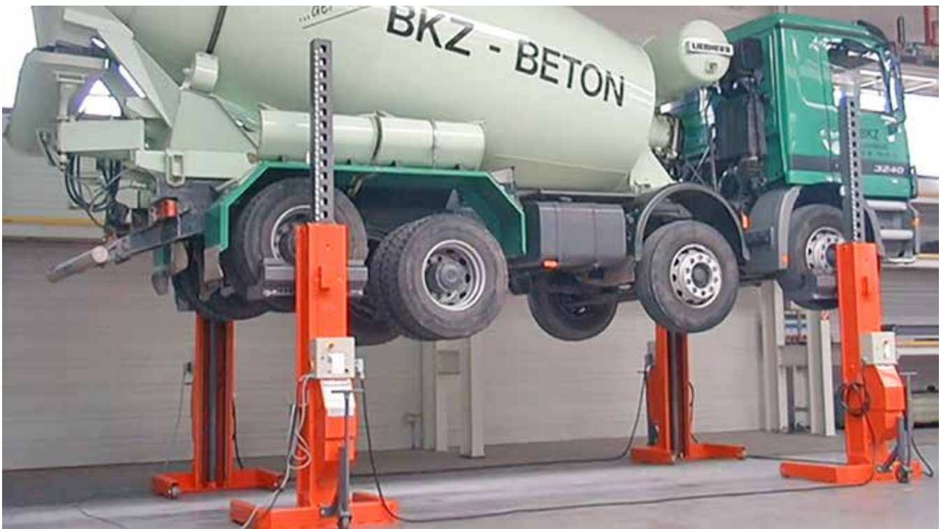
EHB707V25DC-4-PR407 - 4x7 t, wireless, ruota da Ø550-2500 mm, forche da 700 mm
