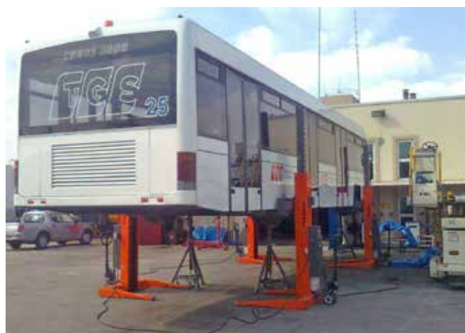
EHB706G1-4 - 4x6,5 t , wireless, ruota da Ø550-1420 mm, forche da 590 mm
