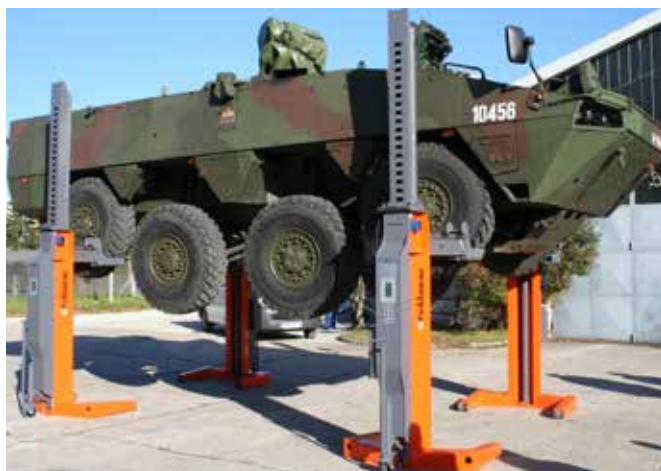
EHB907V14DC-4 - 4x7,5 t , wireless, ruota da Ø550-1490 mm, forche da 385 mm
