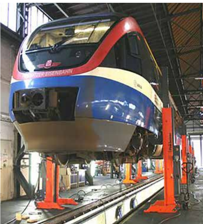
EHB912KDC 12 t , wireless, corsa utile di sollevamento 1750 mm
