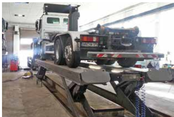
Sollevatore a pantografo HDS in un'officina per riparazione di veicoli pesanti
