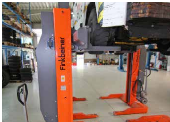
EHB706G1DC-4 - 4x6,5 t , connessione via cavo ruota da Ø550-1420 mm, forche da 590 mm
