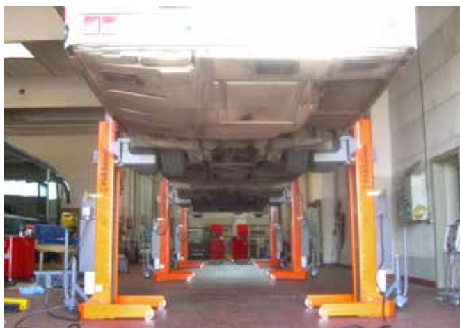
EHB710V19DC-4-PR399 - 4x10 t , wireless, ruota da Ø400-1900 mm, forche da 450 mm
