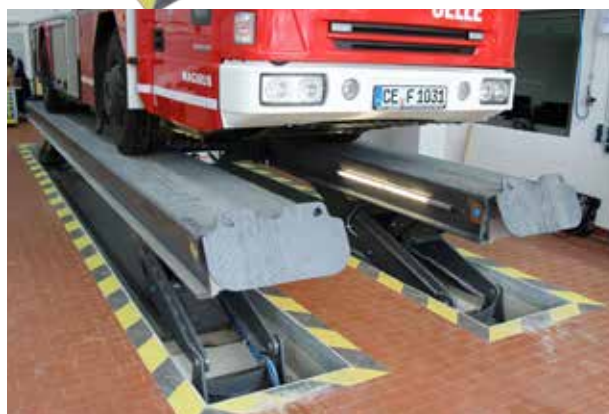
Sollevatore Finkbeiner HDS 25 con piattaforme esposte dalla sede a scomparsa nel pavimento
