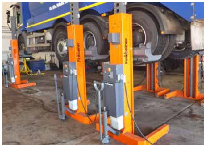
EHB907V14DC-6 - 6x7,5 t , wireless, ruota da Ø550-1490 mm, forche da 385 mm
