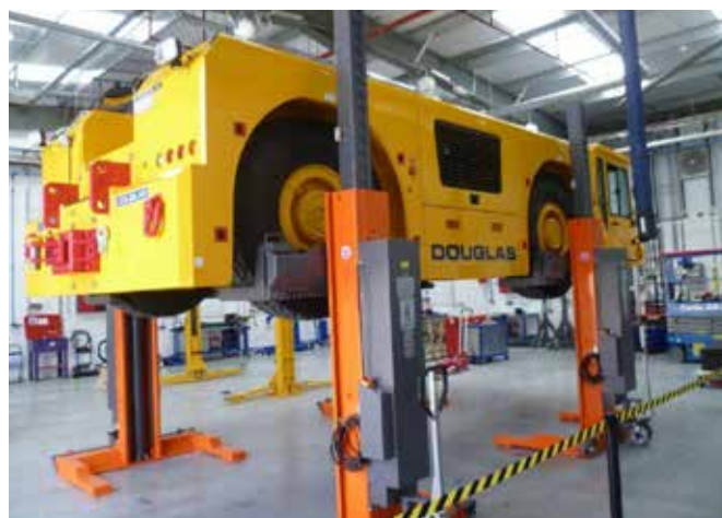
EHB710V16DC-4-PR248 - 4x10 t , wireless, ruota da Ø550-1600 mm, forche da 450 mm
