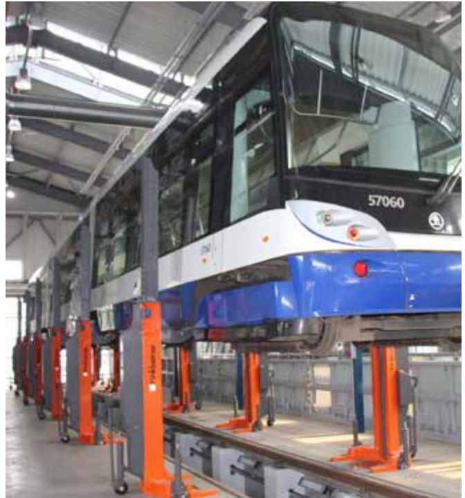
EHB907K-FDC01 - 7 t , wireless, corsa utile di sollevamento 1750 mm
