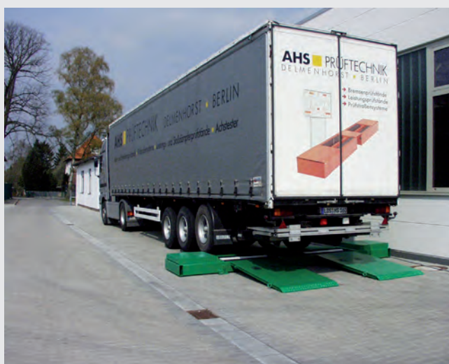
Banco prova freni mobile per autocarri, ideale per chi deve operare come pre-revisione in piazzali di proprietà o presso la propria clientela
