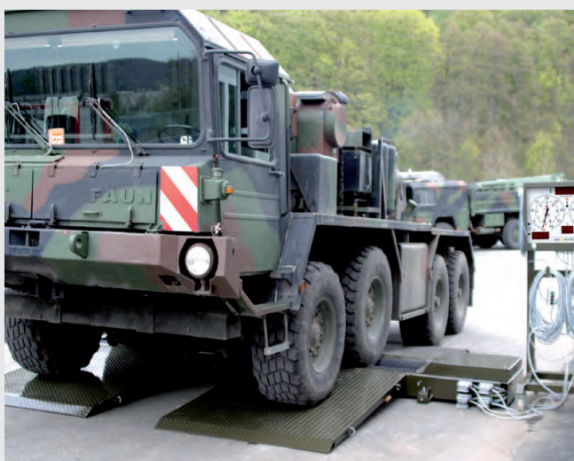
Banco prova freni mobile per autocarri, ideale per chi deve operare come pre-revisione in piazzali di proprietà o presso la propria clientela
