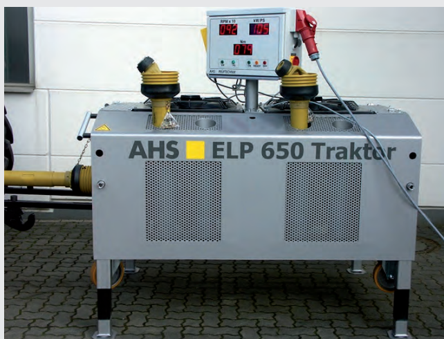
Strumentazione professionale per la prova potenza motori agricoli con presa diretta sul cardano. Prodotto consigliato e preventivato dopo una specifica consultazione tecnica con il personale commerciale.
