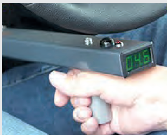
Prova sforzo al pedale. Nuovo modello manuale wireless o a connessione tradizionale con cella di carico applicata al pedale
